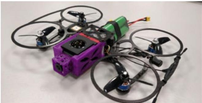
Abb. 3: DIY-Drohne mit ArduPilot-Steuerung, gefrästem Carbon-Gehäuse und drei Kameras für FPV-Livestreaming, 360°-Rundumsicht und KI-basierter Objekterkennung
