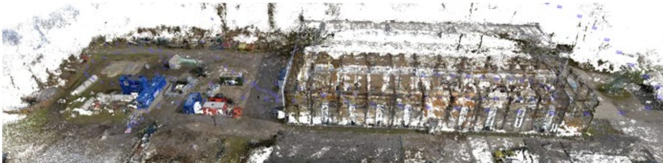
Abb. 1: Detaillierte Punktwolken eines exemplarischen Inspektionsfluges der Halle des Deutschen Rettungsrobotik Zentrum in Dortmund mit einer unserer selbstgebauten UAVs (Unmanned aerial vehicles)
