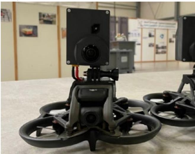
Abb. 2: Modifizierte DJI AVATA mit 360°-Kamera und Wärmebildsensor (TiR 360) für effektive Echtzeit-Inspektionen von Brandherden und Wärmequellen
