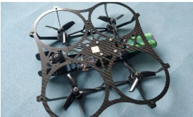
Abb. 4: Der Carbon Copter — eine kostengünstige Eigenbau-Drohne mit integrierter 360°-Kamera für vollständige Panoramasicht
